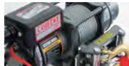
Verricello elettrico, potenza di 12v e cavo per il controllo remoto con una capacità di 1678 kg (optional).
